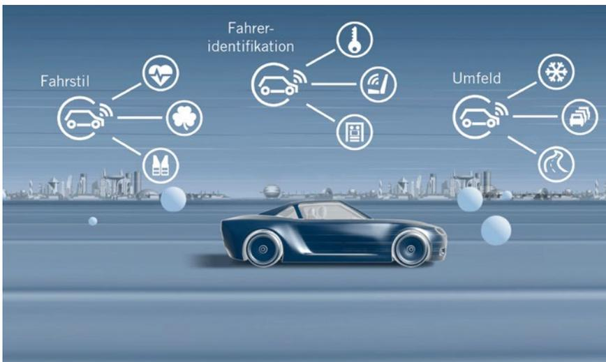
Vertrauen der Fahrzeuginsassen zu gewinnen, sollte der Fahrer in die Regelung einbezogen werden. Hierzu werden Umfelddaten des Fahrzeugs und der Fahrstil des Fahrers analysiert, damit das Fahrerassistenzsystem an das Verhalten des Fahrers angepasst werden kann. Durch intuitive Interaktion mit dem Assistenzsystem und dessen verbesserter Reaktion auf neue Situationen fühlt sich der Fahrer vom Fahrzeug „verstanden“, die gefühlte Zuverlässigkeit steigt.
