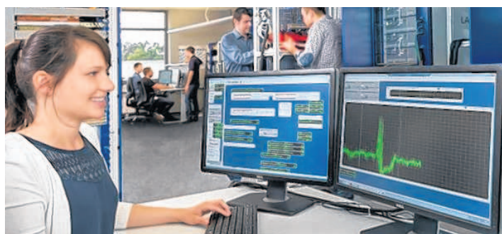
Hardware-in-the-Loop (HiL)-Prüfstände sichern die Funktionalität von Software elektronischer Systeme im Fahrzeug.
