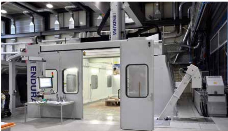
**SUV-tauglicher Bearbeitungsraum** : Die Focke-Maschinen können mit einem Arbeitsraum von 7,5 × 3,5 × 2,5 m auch große Werkstücke problemlos bearbeiten. (© Bertrandt AG)
