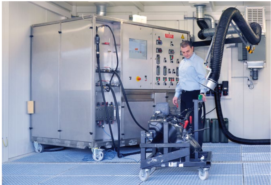
BILD 1 Absicherung der Betankungsqualität und Befüllbarkeit mit einem Prüfstand (© Bertrandt)
