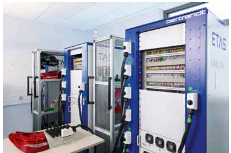
Bild 3: HiL-Test der Komponente „Heckleuchte“ des Teilsystems „Licht“. (© ETAS)
