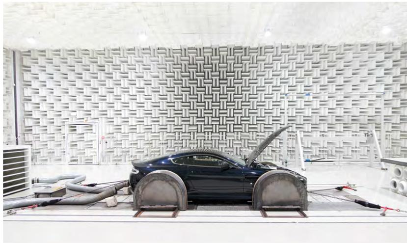
▲ Abb: 6: Akustik-Allrad-Rollenprüfstand in Sassenburg
