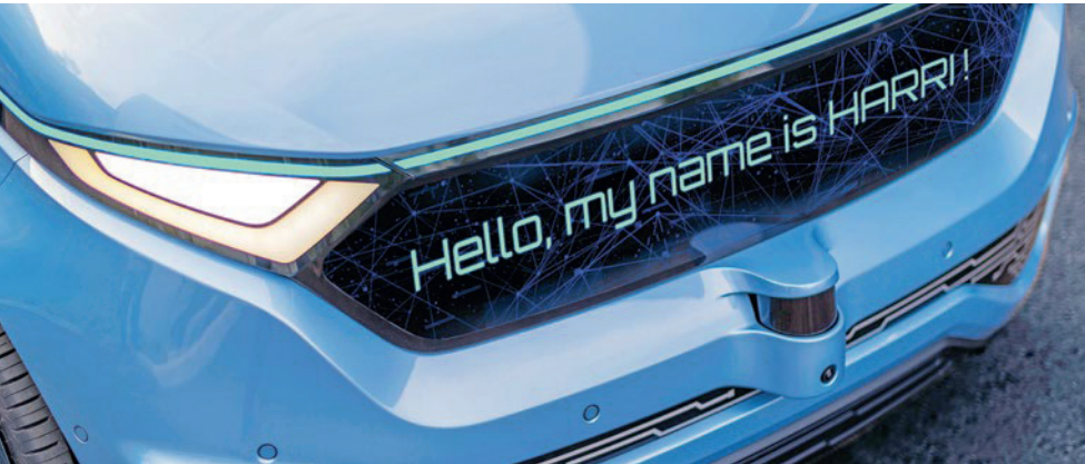
BILD 3 Durch Botschaften auf den Curved-Monitoren mit LED-Bildschirmen vorne und hinten können Botschaften gesendet werden (© Bertrandt)
