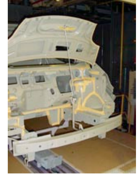
Aufbringung Dichtungsmasse Lackierung.
