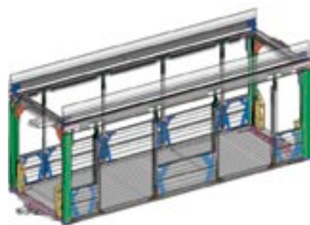
Bei der neuen Lösung verstärken Blech-, Strangpress-, Guss- und Schmiedeteile die Struktur.
