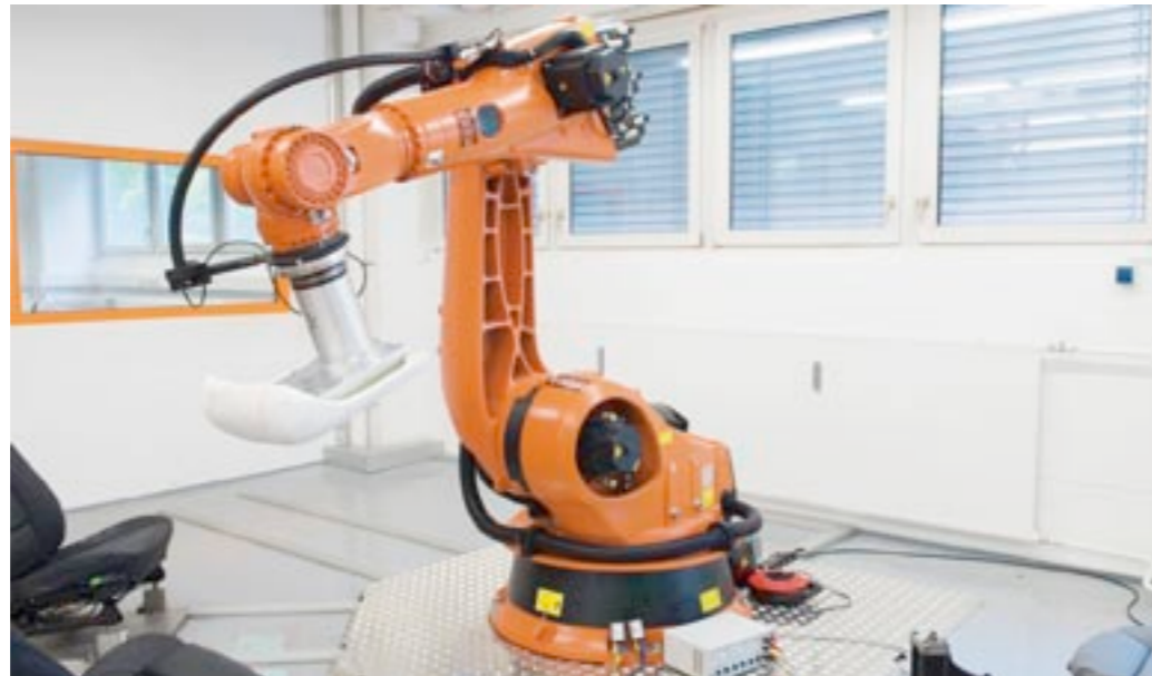
Das „Occubot-System“ in Aktion: Realitätsnahe Ergebnisse durch die flexible Anpassung der Bahn.
