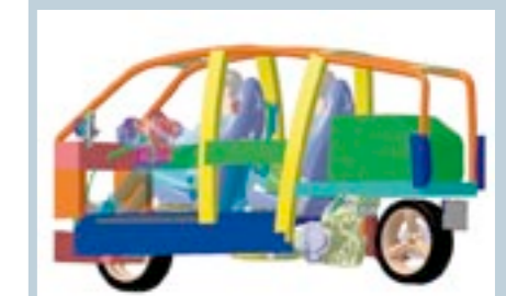
Rohbaukonzept mit Package und Motor-Getriebe-Einheit.
