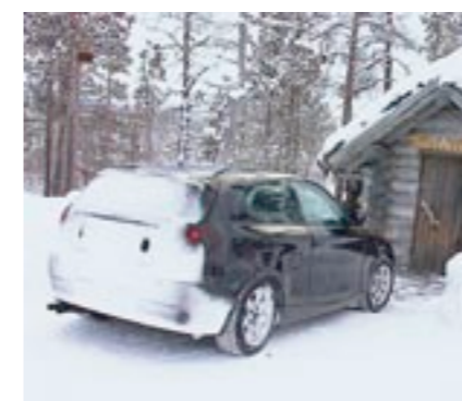
Untersuchung äußerer klimatischer Einflüsse: Extreme Bedingungen bei der Nordlanderprobung (links) oder bei der Hitze- und Verstaubungserprobung in Heißländern (rechts).
