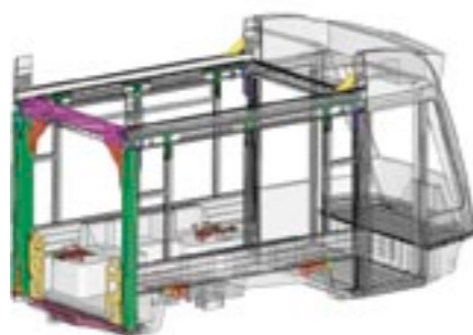
Bei der neuen Lösung verstärken Blech-, Strangpress-, Guss- und Schmiedeteile die Struktur.
