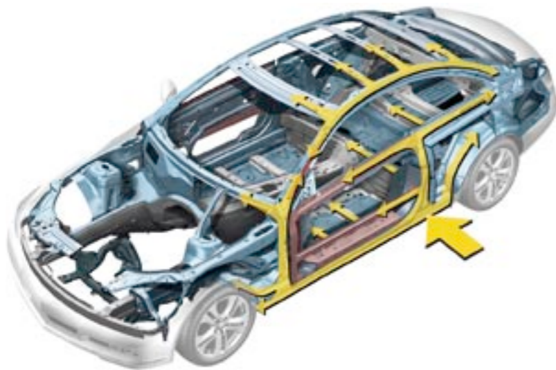
Die hohe Festigkeit der Dachsäulen, des Dachrahmens und der seitlichen Längsträger sorgen für bestmöglichen Schutz der Insassen.
