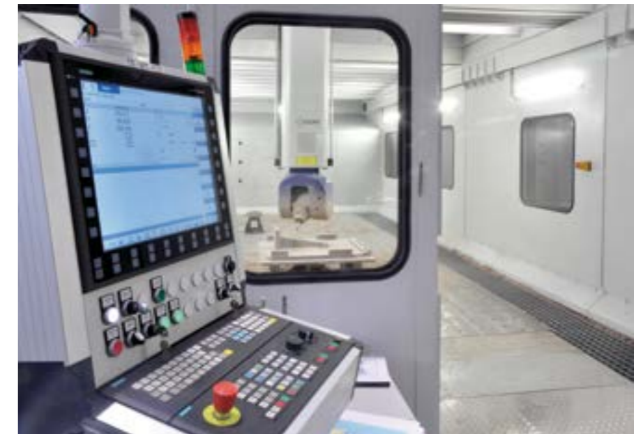
Die Endura 904LINEAR kann sowohl im Trocken- als auch im Nassbetrieb arbeiten.
