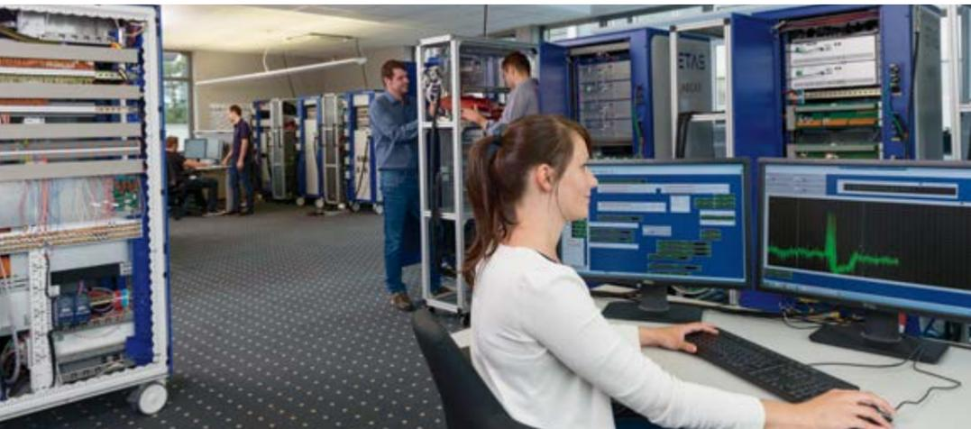
Bertrandt bietet seinen Kunden Rundum-Tests der kompletten Fahrzeugelektronik von der Testspezifikation bis zur Freigabe an: im neuen Testhaus mit leistungsfähigen HiL- (Hardware-in-the-Loop)-Prüfständen. Dort können E/E-Tests vollautomatisch, modular und skalierbar mit großer Breite und Tiefe effizient durchgeführt werden.
