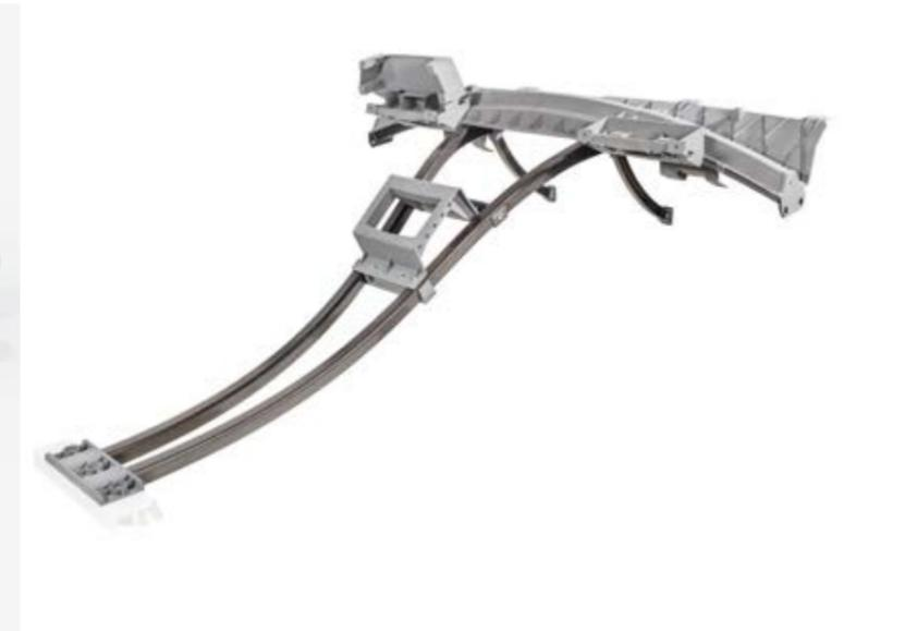
Die Längsträgerkonsole: BMC/SMC mit TowPreg-Einfassung.
