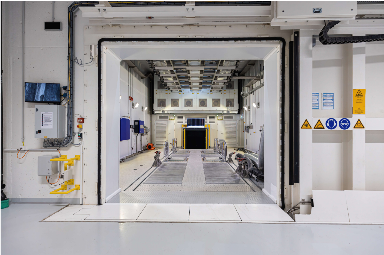
Rollenprüfstand mit Höhenkammer und Sonnenlichtsimulation
